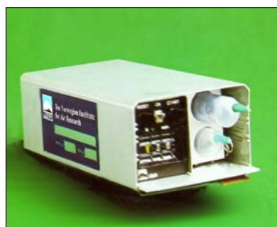
Zdjęcie – Zasilane bateriami. zintegrowane urządzenie do poboru prób gazów wskaźnikowych z wbudowanym regulatorem czasu.
